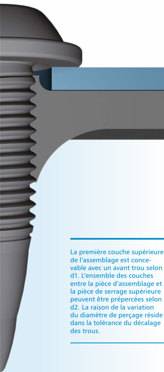
Assemblage de deux tôles préperçées 1 x
