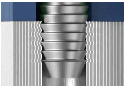
Kraft- und formschlüssige Verbindung
