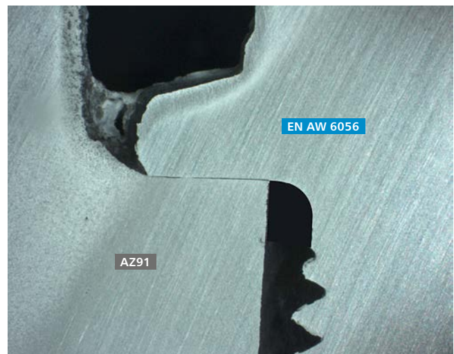
Kontaktstelle Alufast ® Schraube (EN AW 6056) und Gehäuseflansch (AZ91) nach 720 h NSS (ISO 9227)
