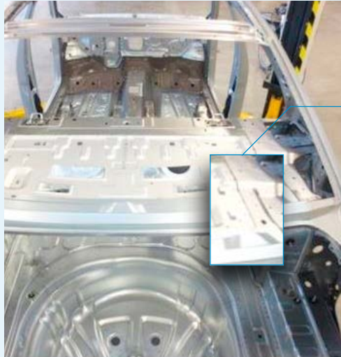
Aluminium-Hutablage widerstandselementgefügt in Stahl Karosserie VW Passat B8
