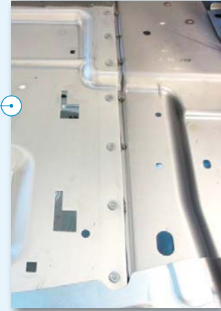
Aluminium-Hutablage widerstandselementgefügt in Stahl Karosserie VW Passat B8
