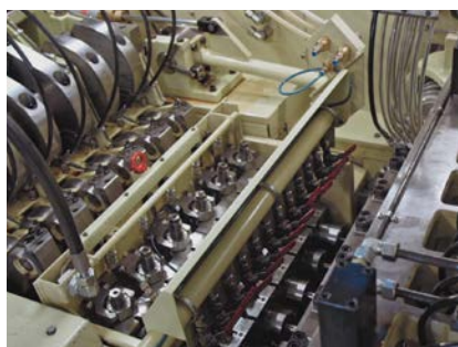
Über diverse Umformungsstufen werden die Teile nach und nach in die gewünschte Form gebracht.
