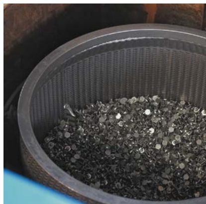
Um hohe Sauberkeit der Teile zu gewährleisten, werden alle Teile nach jedem mechanischen Arbeitsgang gereinigt.
