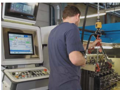
Der Werkzeugblock wird außerhalb der Maschine vorgerüstet und von einem Mitarbeiter eingebaut.
