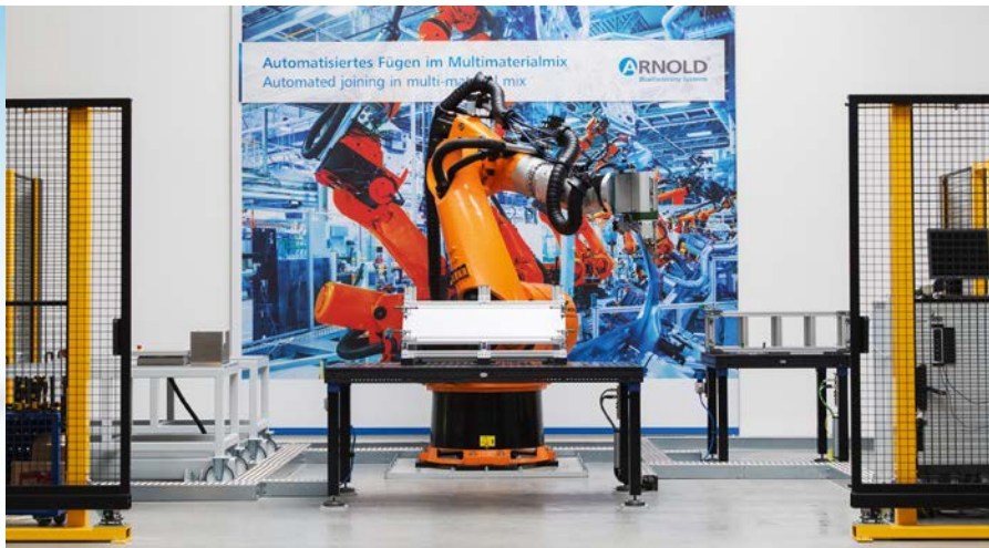
Bild 3: Im Blechfügelabor ist es möglich, unter realistischen Bedingungen seriennah zu agieren. Der Kunde erhält die relevanten Verschraub-Parameter für seinen konkreten Anwendungsfall. (Bild: ARNOLD UMFORMTECHNIK)
