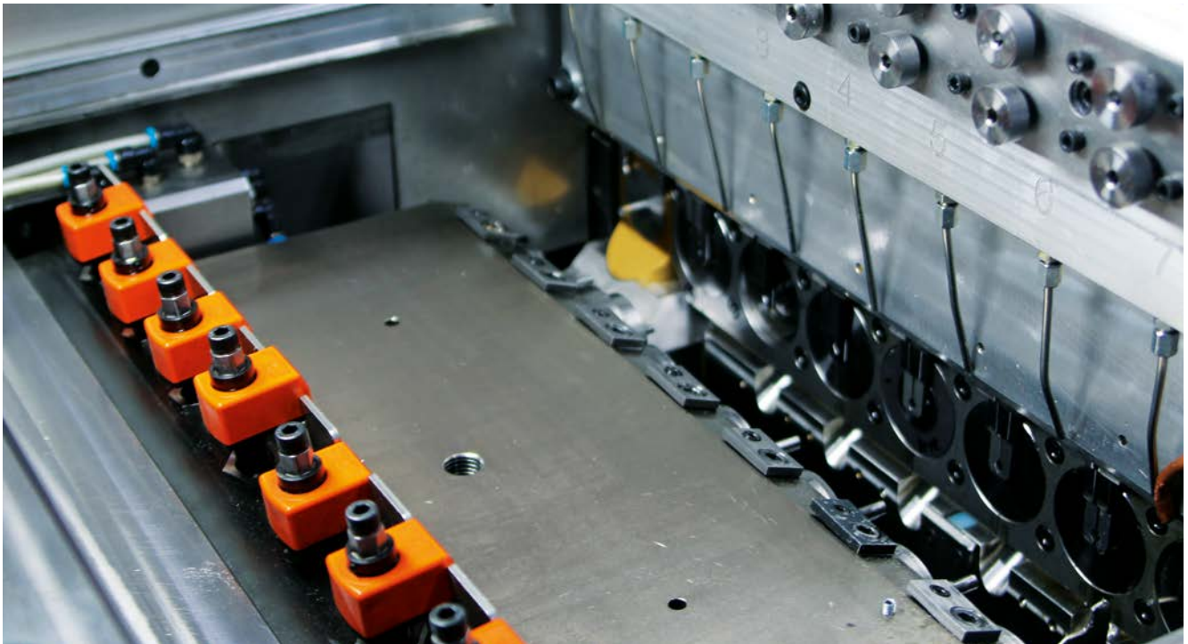
Bild 2: Die 7-Stufen-Pressen verfügt über eine Gesamtpresskraft von 1.100 kN und ist mit einer integrierten induktiven Vorwärmanlage ausgestattet. (Bild: ARNOLD UMFORMTECHNIK)
